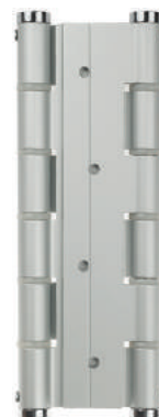
Петля пружинная двойная 5914.02 180X133X4 матовый хром Выдерживает: 2 петли до 40 кг, 3 петли до 60 кг
