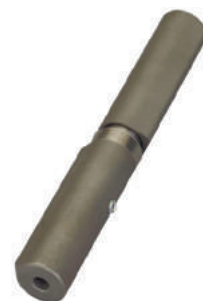
Петля приварная для металлических дверей ALDEGHI Ø22X25 мм с функцией доводчика, левая Исполнение петли: есть и правая и левая цвет: никель материал: сталь выдерживает: 2 петли до 75 кг 3 петли до 90 кг
