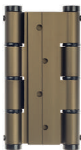
Петля пружинная двойная 5414.02 120x133x4 античная бронза Выдерживает: 2 петли до 40 кг, 3 петли до 60 кг
